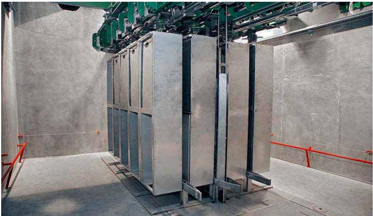
*Cámara de irradiación de la Unidad Radiante 2*
